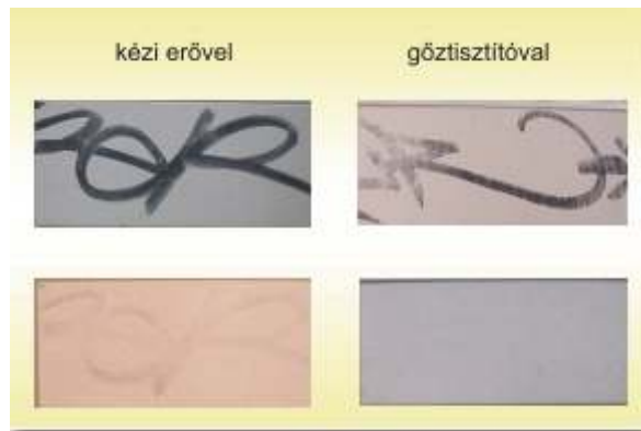
6. ábra Graffiti eltávolítása Nanocoll MILD oldószerrel, kézi erővel illetve gőztisztítóval
