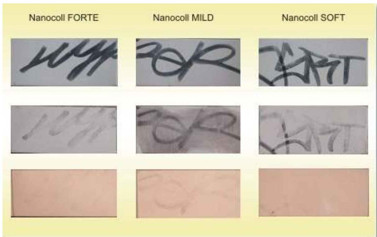
5. ábra Graffiti eltávolítása Nanocoll FORTE, Nanocoll MILD és Nanocoll SOFT oldószerekkel, kézi erővel, majd magasnyomású mosóval
